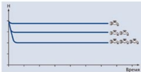
Работа ACUAPRES – стабильное давление в системе при неизменном потреблении воды.
