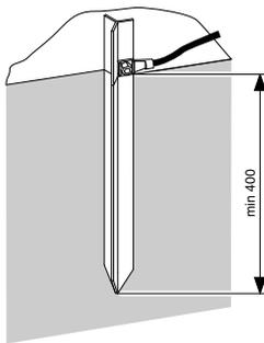
Рис. 3.20 Заземляющий стержень
