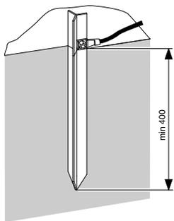
Рис. 3.23 Заземляющий стержень
