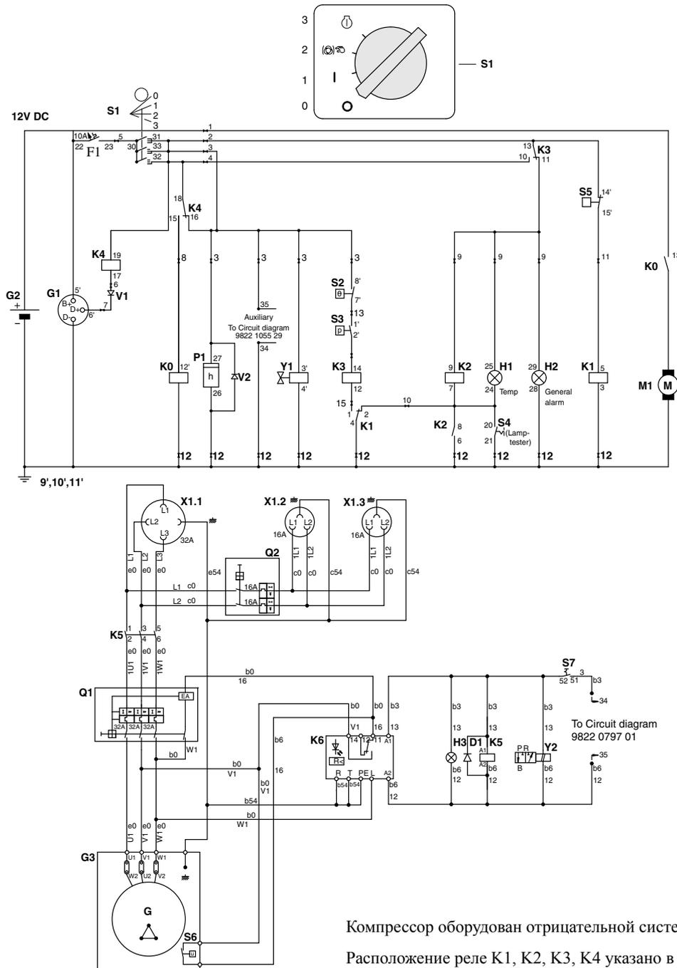
Компрессор оборудован отрицательной системой заземления.
