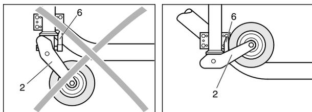
Рис. 3.6 Буксировочное положение направляющего колеса
