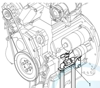
Рис. 3.10 Противообледенительное устройство
