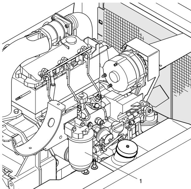
Рис. 5.4 Топливный фильтр
