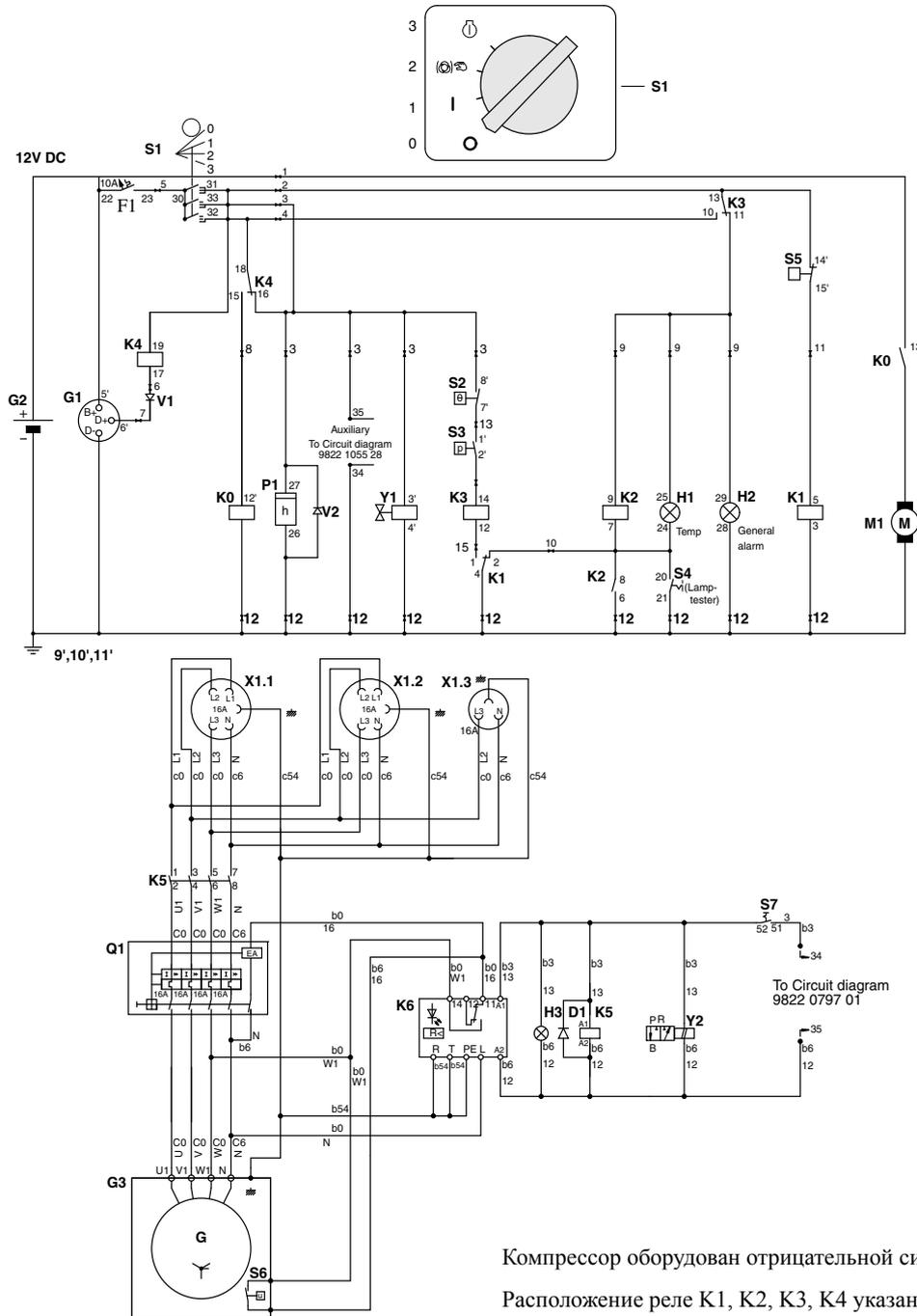
Компрессор оборудован отрицательной системой заземления.
