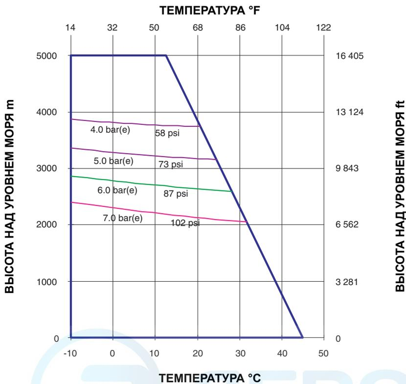
**Кривые зависимости производительности установки от высоты над уровнем моря XAS 67 DDG - XAS 130 DD7G 12 kVA**
