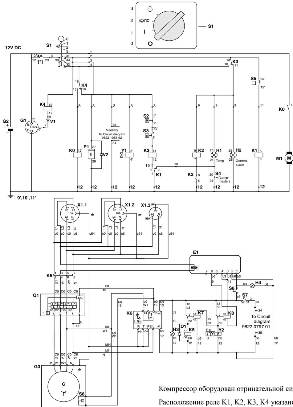
Компрессор оборудован отрицательной системой заземления.
