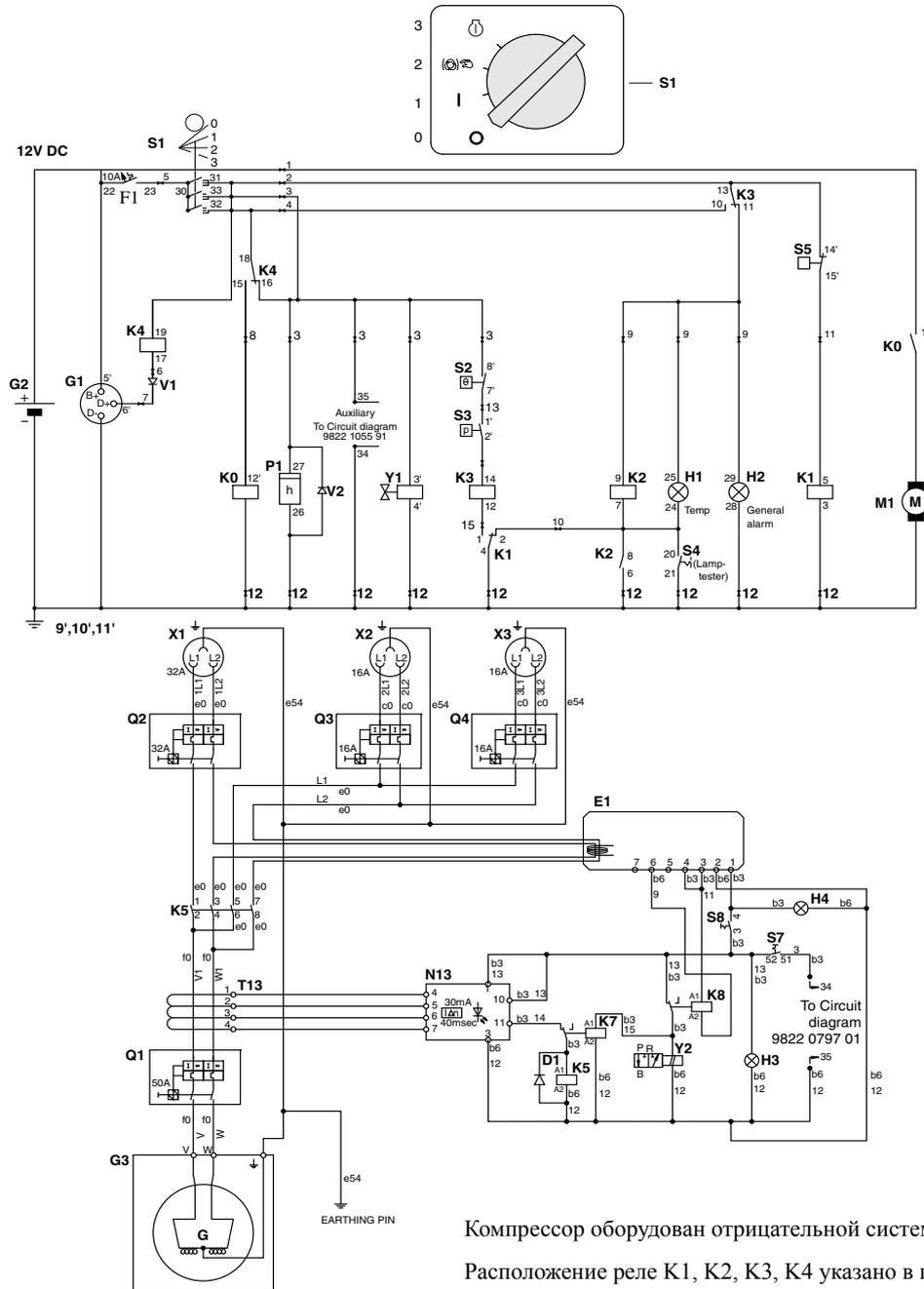
Компрессор оборудован отрицательной системой заземления.
