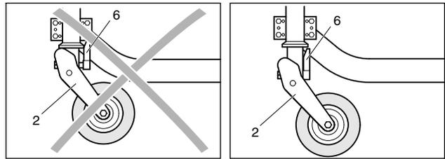
Рис. 3.3 Положение парковки направляющего колеса
