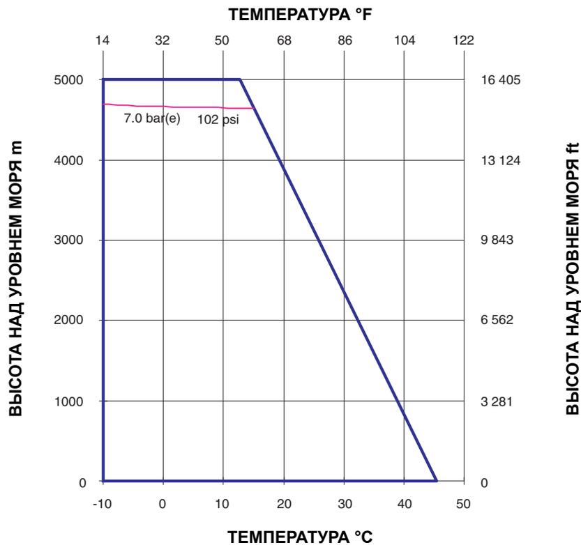
**Кривые зависимости производительности установки от высоты над уровнем моря XATS 67 DD - XATS 125 DD7**
