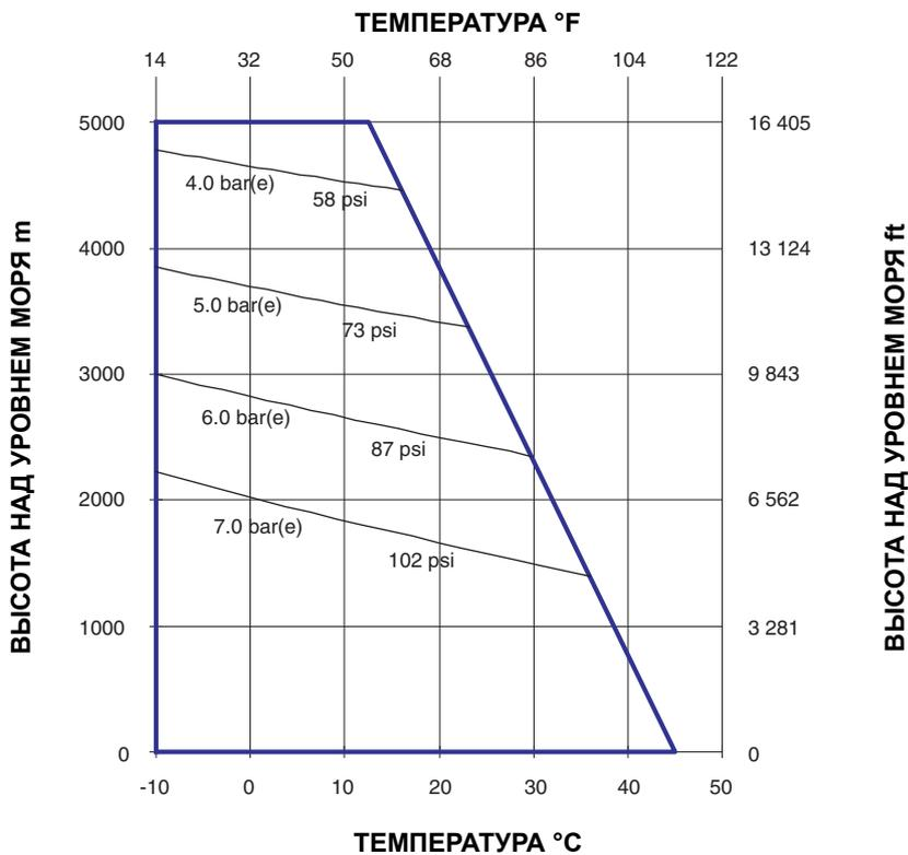
**Кривые зависимости производительности установки от высоты над уровнем моря XAS 97 DD - XAS 185 DD7**
