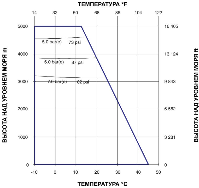
**Кривые зависимости производительности установки от высоты над уровнем моря XAS 67 DDG - XAS 130 DD7G 6 kVA**
