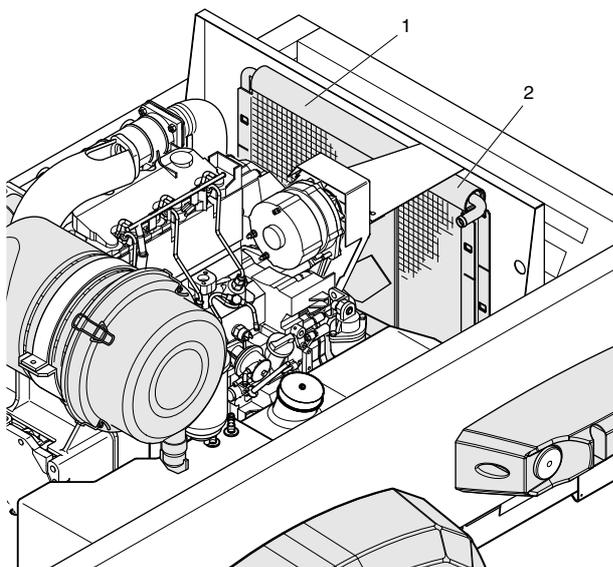
Рис. 4.3 Маслоохладитель компрессора (1) и маслоохладитель двигателя (2)
