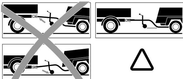
Рис. 3.5 Табличка на буксирной балке, инструкция по буксированию
