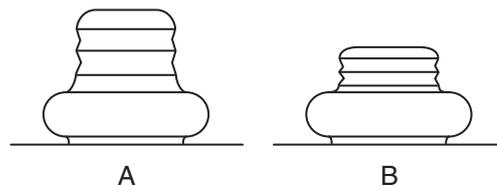
Рис. 3.12 Положения кнопки автоматического выключателя
