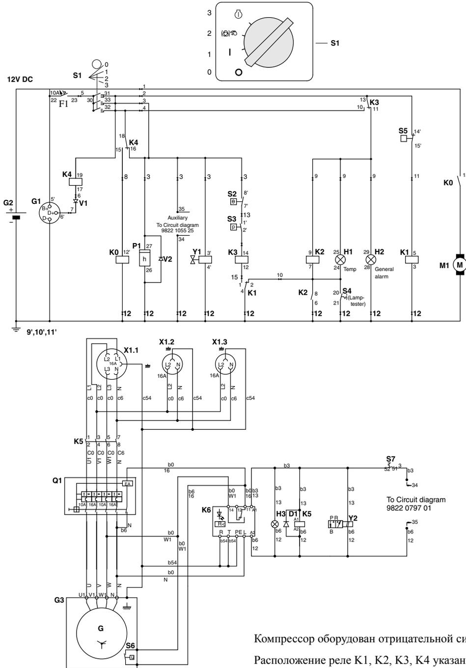
Компрессор оборудован отрицательной системой заземления.
