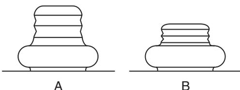
Рис. 3.18 Положения кнопки автоматического выключателя
