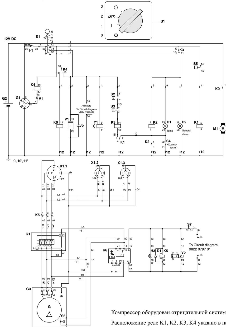
Компрессор оборудован отрицательной системой заземления.
