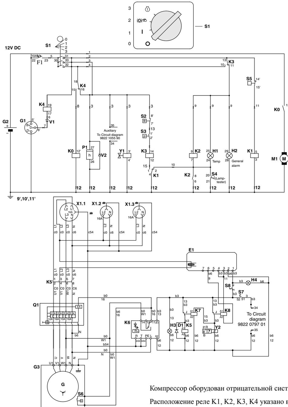
Компрессор оборудован отрицательной системой заземления.
