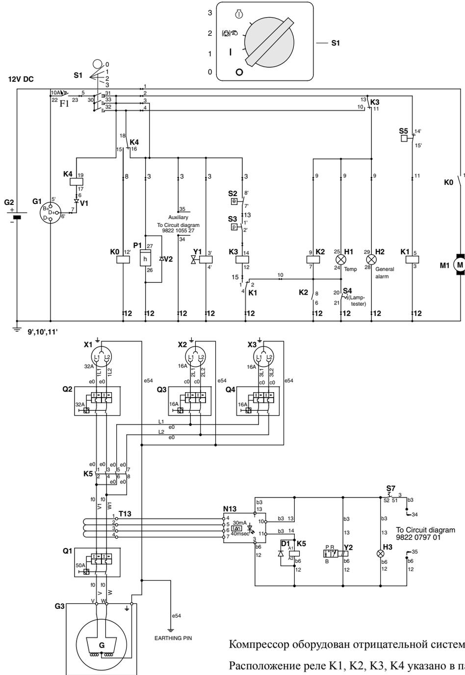
Компрессор оборудован отрицательной системой заземления.
