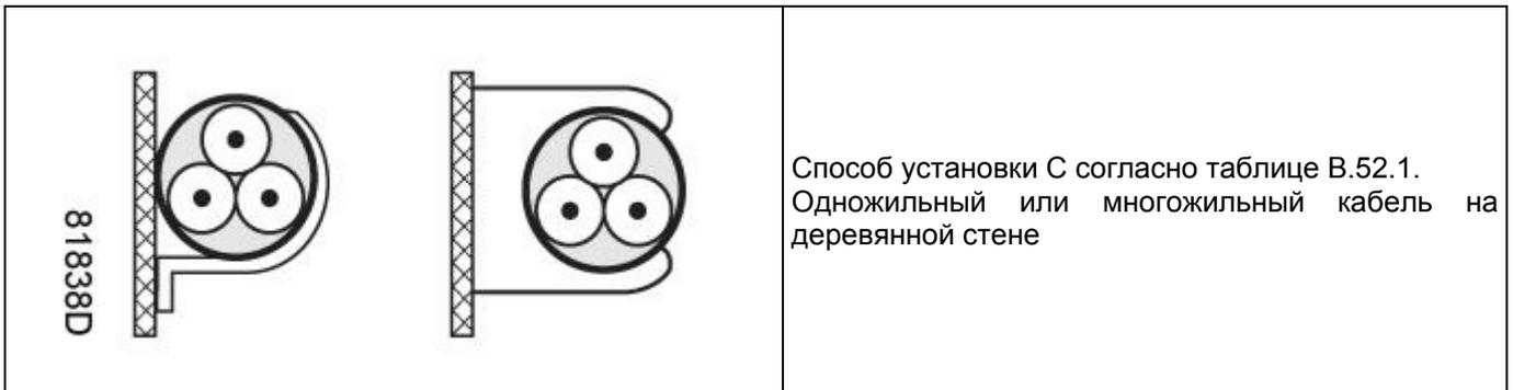
Максимальная допустимая токовая нагрузка в зависимости от температуры окружающей среды для метода установки С
