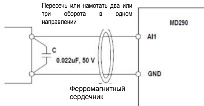
Рис. 4-6. Установить фильтрующий конденсатор или ферромагнитный сердечник
