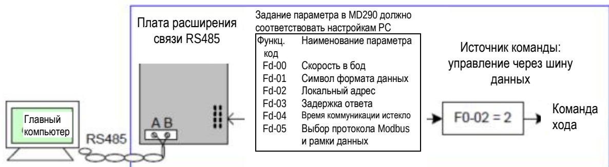
Рис. 5-8. Задание пуска/остановки в режиме управления через шину данных
