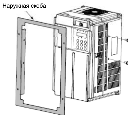
Рис. 3-5. Встраиваемый монтаж для MD290 (пластмассовый корпус)
