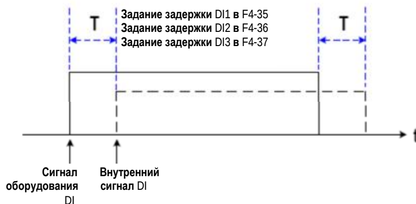
Рис. 5-30. Задание функции задержки сигнала DI
