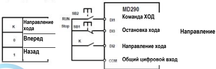
Рис. 7-14. Режим трехпроводного управления 2
