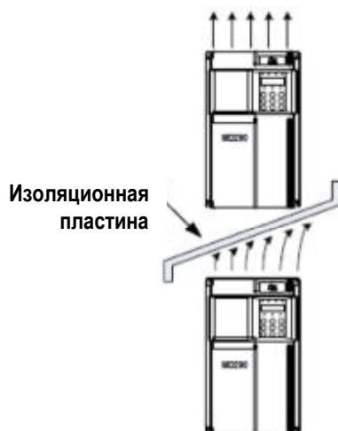
Рис. 3-2 Установка изоляционной пластины
