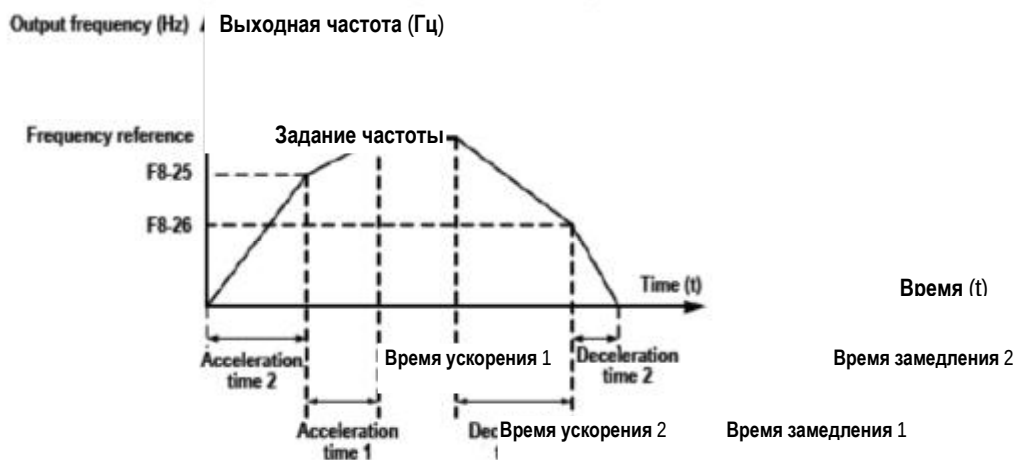
Рис. 7-26. Переключение между временем ускорения и временем замедления
