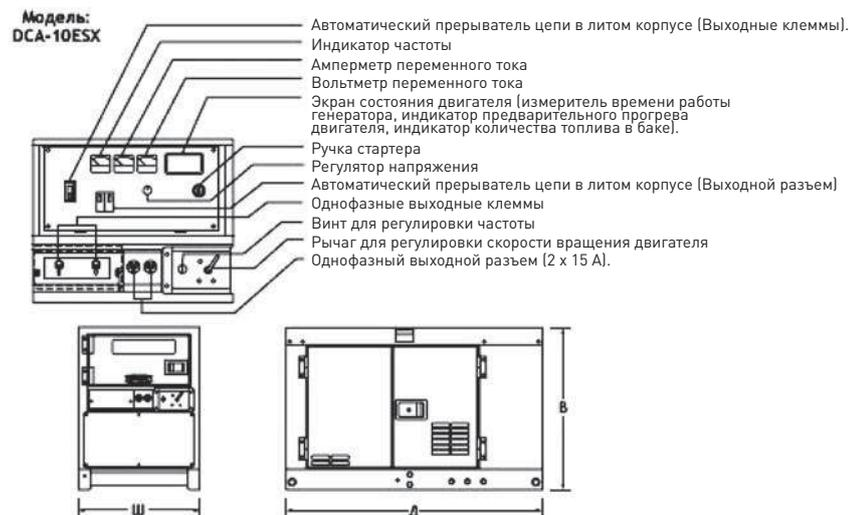
Габаритные размеры (моделей, предназначенных для установки на транспортных средствах).
