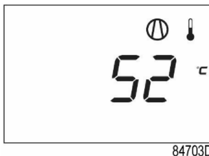
Главный экран с температурой (остановлен компрессор)
