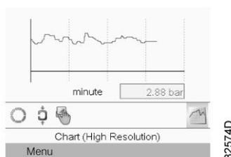
При выборе вида График (высокое разрешение) на экран выводится динамика изменения выбранного входного сигнала (в данном примере это давление) за минуту. Также выводится мгновенное значение параметра. На экран выводятся данные за последние 4 минуты.
