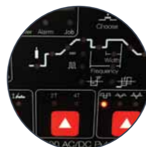
Профессиональная панель управления с «параметрической кривой»
