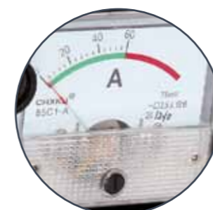
Индикатор зарядного тока (амперметр)
