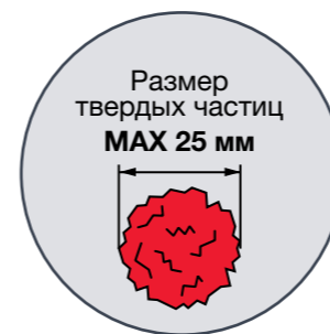
Возможность качать воду с частицами до 25 мм
