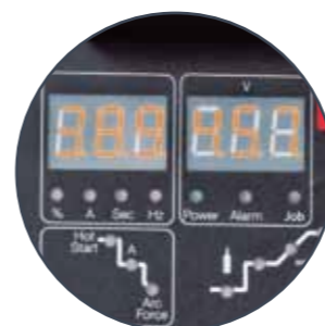
Цифровая индикация параметров сварки
