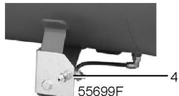
*Клапан дренажа конденсата на воздушном ресивере*
