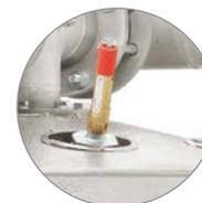
**Предохранительные клапаны резервуара**
