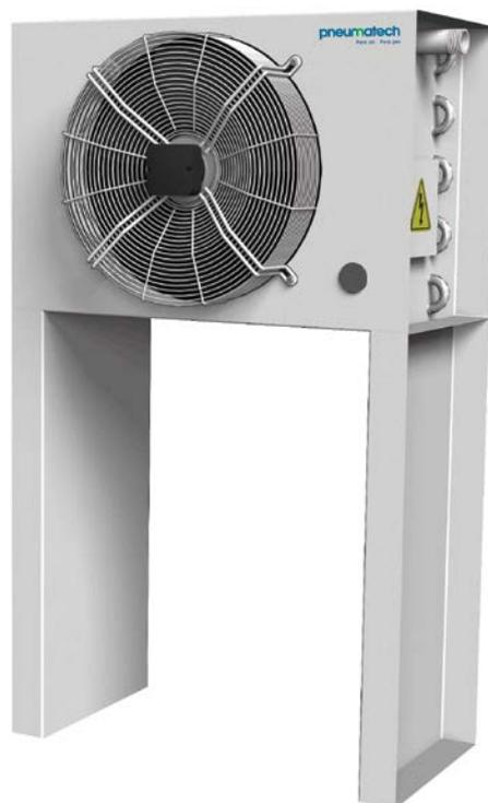
Сжатый воздух на выходе из компрессора всегда на 100% насыщен водой. Кроме того, температура на выходе оказывает большое влияние на водяную нагрузку после компрессора. Чтобы снизить нагрузку и, как следствие, размер расположенных далее рефрижераторных или адсорбционных осушителей, рекомендуется установка высокопроизводительного концевых охладителя между компрессором и осушителем.
