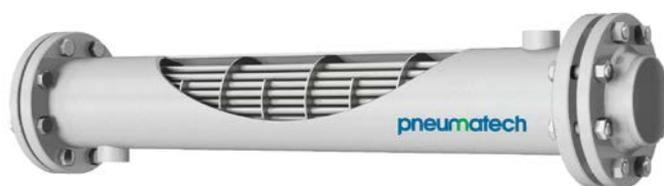
Сжатый воздух на выходе из компрессора всегда на 100% насыщен водой. Кроме того, температура на выходе оказывает большое влияние на водяную нагрузку после компрессора. Чтобы снизить нагрузку и, как следствие, размер расположенных далее рефрижераторных или адсорбционных осушителей, рекомендуется установка высокопроизводительного концевого охладителя между компрессором и осушителем.
