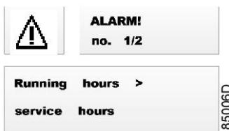
Если активны один или несколько аварийных сигналов, экран аварийной сигнализации отключает основной экран.
