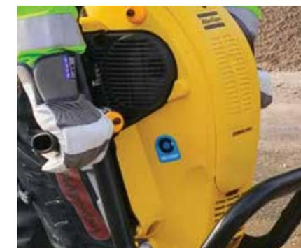
**Простой запуск** Декомпрессионный клапан и электронная система зажигания, которыми оснащена модель Cobra™ Pro, обеспечивают простой запуск в любых погодных условиях. Кроме того, процедура запуска облегчена благодаря использованию крышки бака улучшенной конструкции.
