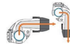
Клапаны быстрого сброса давления обеспечивают герметичность и защиту линии сброса от конденсата
